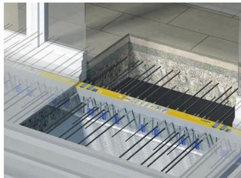
elemento termoisolante per strutture aggettanti
