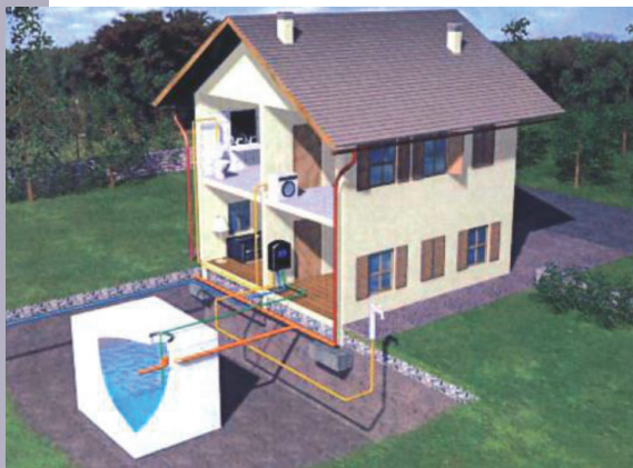
esempio di impianto recupero acqua piovana
